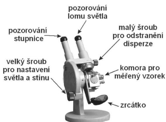
Konstrukční a ovládací prvky Abbeho refraktometru
